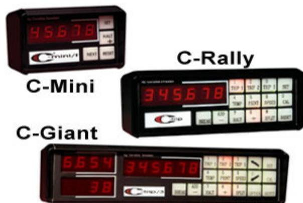
Los tres diferentes modelos Coralba (*C-Mini*, *C-Rally* y *C-Giant*) son dispositivos profesionales capaces de medir distancia, tiempo, velocidad, aceleración, temperatura, impulso, combustible, etc., con obtención de datos para análisis de comportamiento del vehículo.
