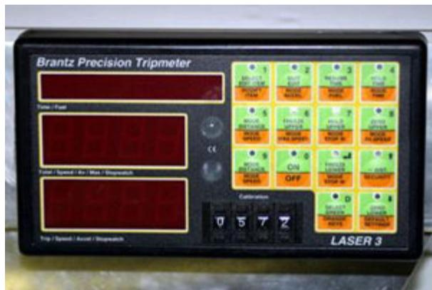
El equipo sofisticado Tripmeter Laser 3 de Brantz ofrece multitud de funciones: distancias (total y parciales, velocidad (media, instantánea, máxima), reloj horario, dos cronómetros, aceleración, combustible, voltímetro, etc.
