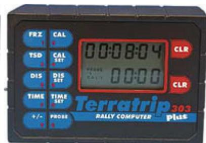
Equipo muy avanzado con doble display para visualización de distancia *total* y de distancia *parcial*, así como la velocidad media en el tramo y la velocidad instantánea del vehículo. Además tiene posibilidad de presentar un reloj horario y un cronómetro.
