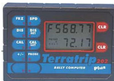
Equipo avanzado con doble display para visualización de distancias *total* y *parcial*, ajustable para correcciones. Tiene la opción de congelación (*freeze*) de distancia. Presenta velocidad instantánea.
