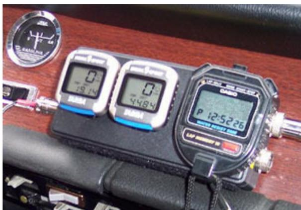
total y otro para distancias parciales, por ejemplo). En la imagen se puede ver un sencillo soporte para dos odómetros de bicicleta junto con un cronómetro de tiempos, colocado en el salpicadero de un clásico, en una posición muy apropiada para su lectura
