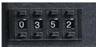
Un conjunto de **interruptores rotativos** de cuatro dígitos que permite establecer la velocidad media requerida, situado en la parte inferior.
